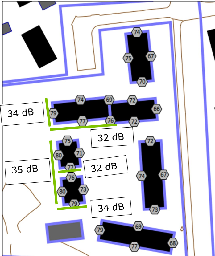
Kuva 3. Suositukset ulkovaipan ääneneristävyyksille 32-35 dB Rw+Ctr enimmäisäänitasojen L AFmax perusteella merkitty kuvaan vihreiden viivojen osoittamille julkisivuille/ julkisivunosille.
